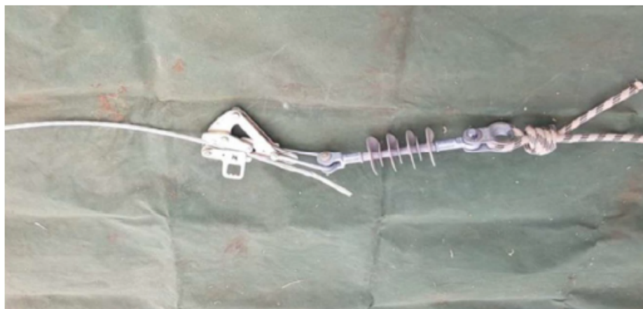
Figura 10: Arranjo para manuseio de cabo conectado ao SEP
